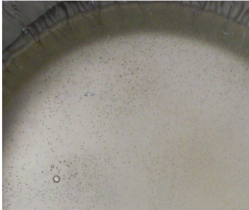
Abbildung 5.42: Makroskopische Aufnahme erhaltener Polymerprobe hergestellt auf 27 mm Extruder bei 600 U/min, 205 °C und 2,5 kg/h
